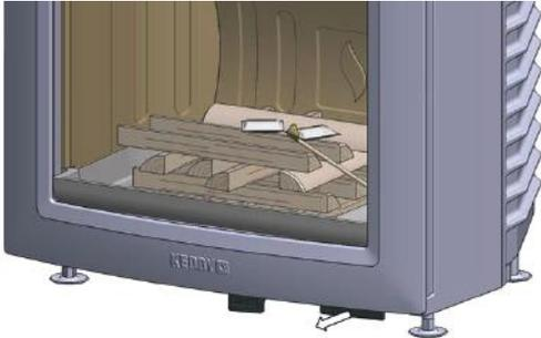
2. Schieben Sie die Klappenregelung max. nach rechts. Legen Sie einige Anzünderstücke auf den Holzstapel und entzünden Sie das Ganze. In den meisten Fällen kann gleich nach dem Entzünden die Tür geschlossen werden.
